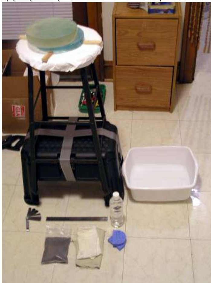
Rycina 10. Przykładowe stanowisko pracy. Raz otwarty proszek trzymamy z dala od proszków drobniejszych.
