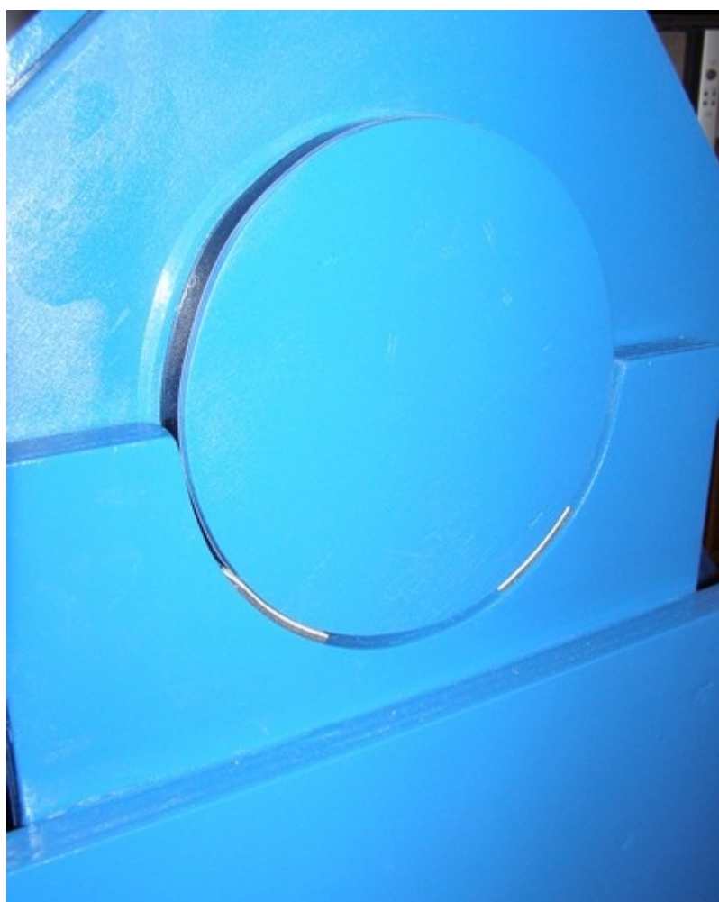
Rycina 117. Gotowe łożysko. Jeśli tarcie jest zbyt małe (tubus „spada” przy najmniejszym dotknięciu), wtedy paski teflonu należy umieścić bliżej siebie. Tarcie nie może być też zbyt duże, tak aby można było z łatwością operować teleskopem jedną ręką.
