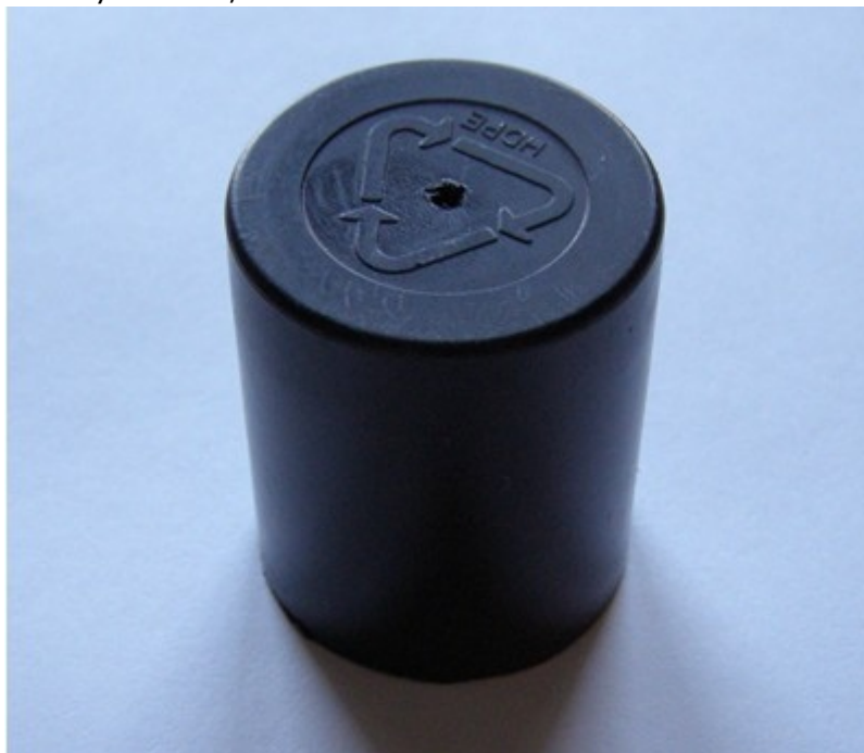
Rycina 111. Okular kolimacyjny wykonany z opakowania po filmie fotograficznym.
