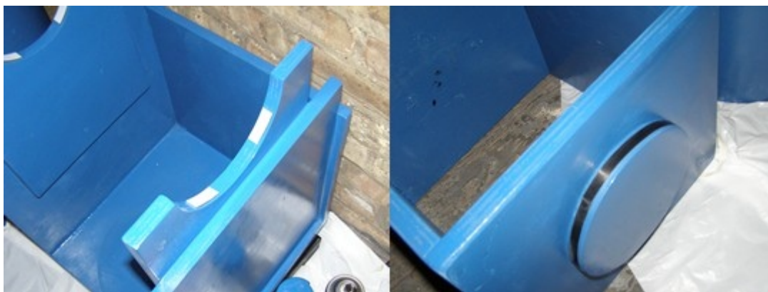
Rycina 116. Wykończenie łożyska. Na widełkach należy umieścić dwa paski teflonu, im większy będzie ich rozstaw tym mniej tarcie będzie występowało na ich powierzchni. Krawędź krążka nośnego należy okleić laminatem — taśmą do wykańczania półek.
