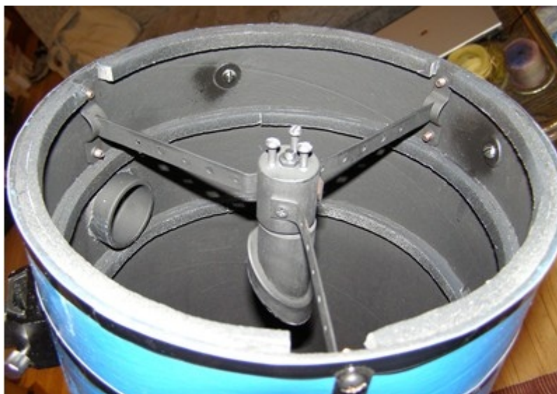
Rycina 118. Na koniec należy zainstalować również pozostałe przesłony i wyczernić pozostałe elementy.
