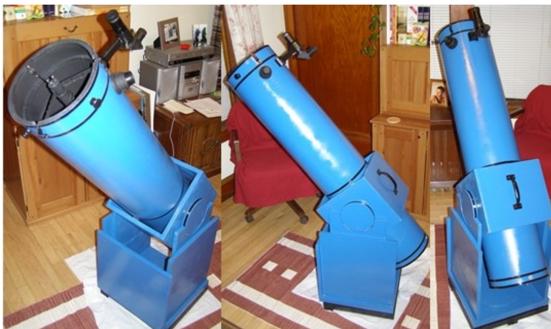
Rycina 119. Skończony teleskop. W celu łatwiejszego przenoszenia na obudowie tubusu można zamocować uchwyt. Z przodu tubusu warto również przytwierdzić gałki, którymi można będzie regulować ustawienie teleskopu.
