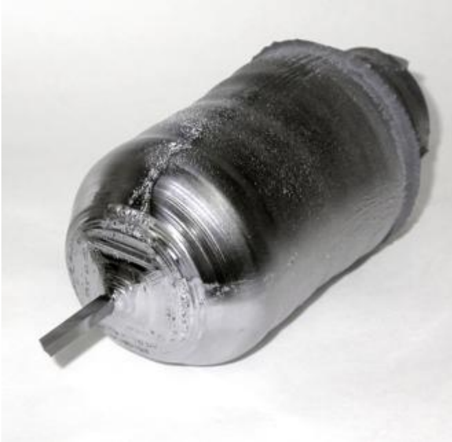
3. Kryształ arsenku galu wyhodowany w Instytucie Technologii Materiałów Elektronicznych w Warszawie. Widoczny pręt, za pomocą którego kryształ był wyciągany z wnętrza tygla. (Źródło: ITME)
