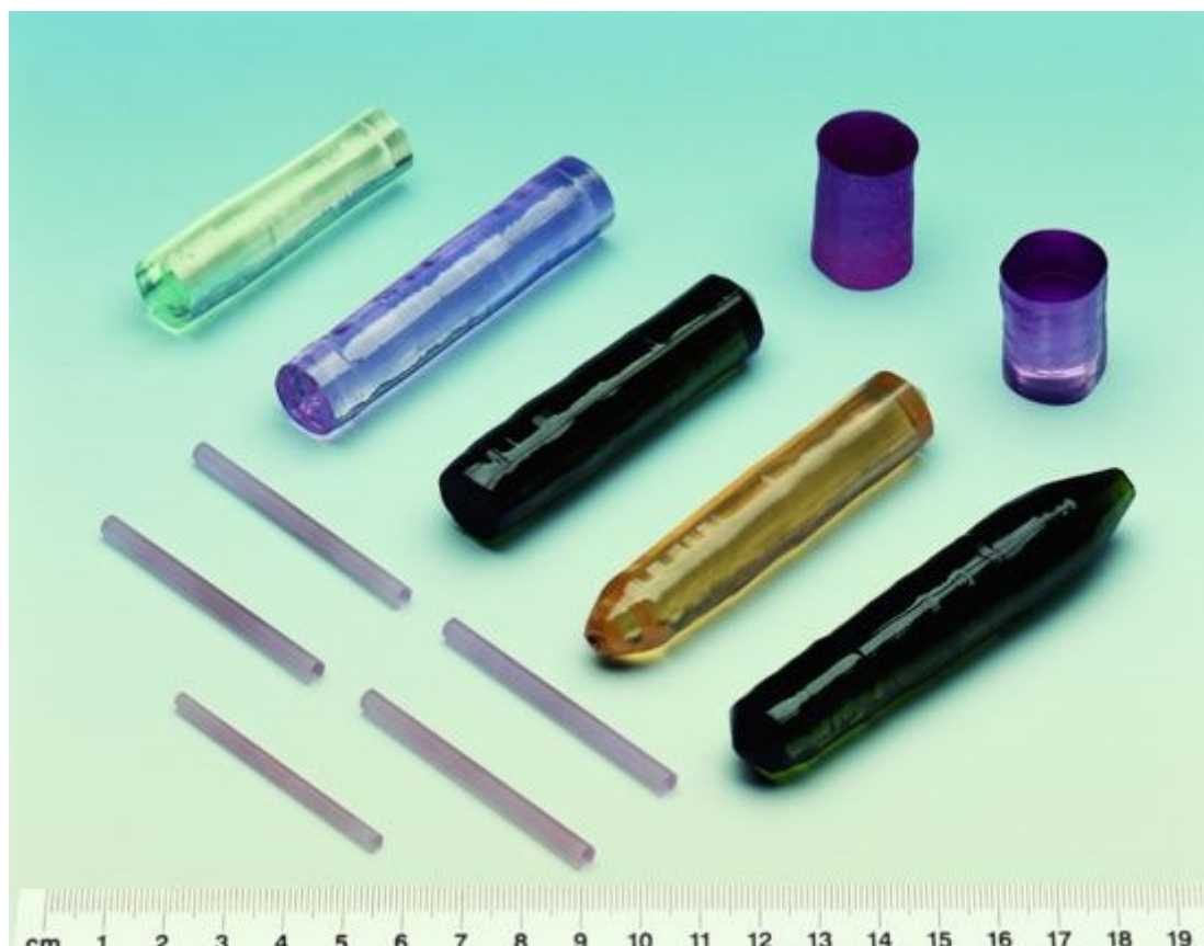
Różne rodzaje monokryształów wyprodukowanych metodą Czochralskiego, przeznaczonych do zastosowań optycznych. W lewym dolnym rogu widoczne gotowe pręty laserowe. (Źródło: ITME)
